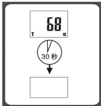
اگر نمایشگر به مدت ۳۰ ثانیه، "۰" یا یک وزن مشخص را نشان دهد دستگاه به صورت خودکار خاموش خواهد شد.
